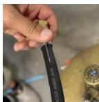
Vérifier l'état du tuyau, sa date de validité et le joint. Visser l'embout de la lyre sur la nouvelle bouteille (ne pas oublier le joint).
